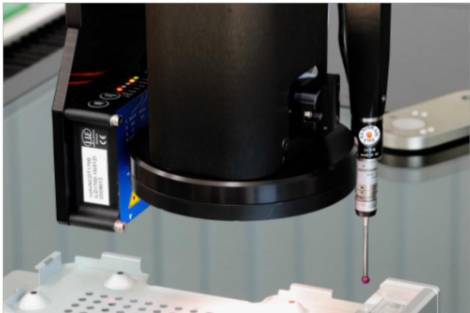
全自动影像测量仪，是在数字化影像测量仪(又名CNC影像仪)基础上发展起来的人工智能型现代光学非接触测量仪器。其承续了数字化仪器优异的运动精度与运动操控性能，融合机器视觉软件的设计灵性，属于当今较前沿的光学尺寸检测设备。全自动影像测量仪能够便捷而快速进行三维坐标扫描测量与SPC结果分类，满足现代制造业对尺寸检测日益突出的要求：更高速、更便捷、更精细的测量需要，解决制造业发展中又一个瓶颈技术。全自动影像测量仪性能使其在各种精密电子、晶圆科技、刀具、塑胶、弹簧、冲压件、接插件、模具有、二维抄数、绘图、工程开发、五金塑胶PCB板、导电橡胶、粉末冶金、螺丝、钟表零件、手机、医药工业、光纤器件、汽车工程、航空航天、高等院校、科研院所等领域具有很广运用空间。
