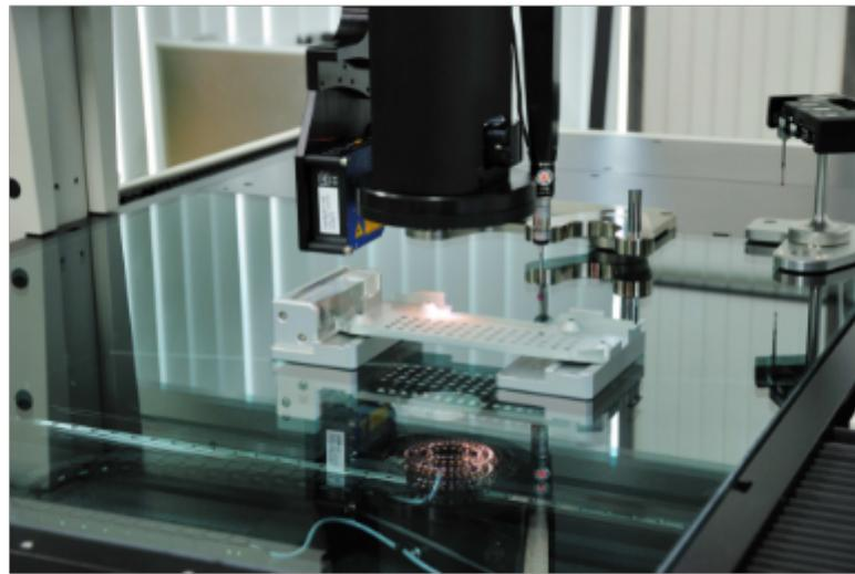
光学影像测量仪它是在测量投影仪的基础上进行的一次质的飞跃，它将工业计量方式从传统的光学投影对位提升到了依托于数位影像时代而产生的计算机屏幕测量。数字化影像测量仪具有运动锁定能力和在设计上采用了无回程间隙技术，从而彻底消除了这些误差，提高了运动的平稳性和测量精度。测量距离越长误差也就越大，测量精度随着长度而降低。手摇式影像测量仪不具备非线性实时纠正功能，无法消除诸如温度、震动等环境因素引起的非线性误差。数字化影像测量仪拥有十分研润企业生产\*\*\*的误差修正能力，通过建立在严格数学模型的软件计算和实时控制来修正，从而使非线性误差降到\*\*小，提高了测量精度，突破了速度与精度的技术瓶颈。四：数字化技术能进行CNC快速测量：手摇式影像测量仪在进行同一工件的批量测量时，需要人工逐一手摇走位，有时\*\*\*得摇上数以万计的圈数，仍然只能完成数十个复杂工件的有限测量，工作效率低下。数字化影像测量仪可以通过样品实测、图纸计算□CNC数据导入等方式建立CNC坐标数据，由仪器自动走向一个一个的目标点，完成各种测量操作，从而节省人力，提高效率。
